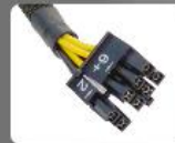
Conector de fuente PCIe de 6 a 8 pines
